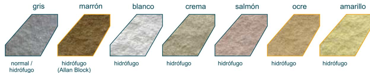
El color gris está disponible en calidades normal e hidrófugo, mientras que todo el bloque de color es hidrófugo, al igual que el bloque split y el Allan Block (para muros de contención) que son todos ellos hidrófugos. Las piezas de calidad hidrófugo (conocido por "Súper") permiten una absorción y succión de agua por capilaridad establecidas por norma; siendo el equivalente de hidrófugo el bloque "cara vista" y el normal el bloque "a revestir".
