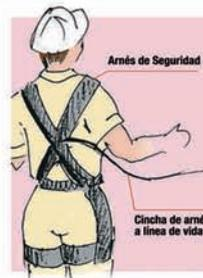
El personal que acceda a la cubierta deberá ir provisto de calzado de seguridad apropiado así como de equipos de protección individual contra caídas en altura, incluyendo cinturón de seguridad (arnés) que se sujetará mediante elemento de amarre a dispositivos fijos de anclaje. La longitud del elemento de amarre será inferior a la altura de la edificación.
