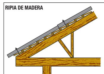
Placa **IMPERLINE®** sobre un soporte de ripia de madera. Fijación mediante tirafondos.
