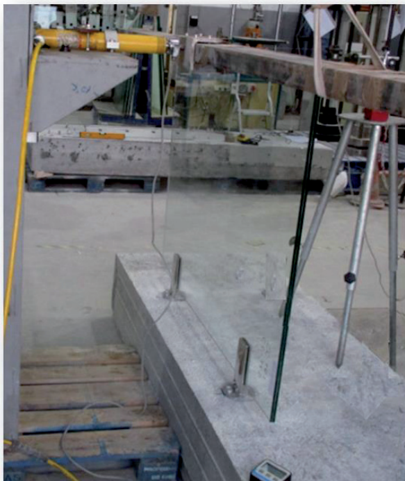
Aspecto tras el empuje horizontal hacia el exterior
