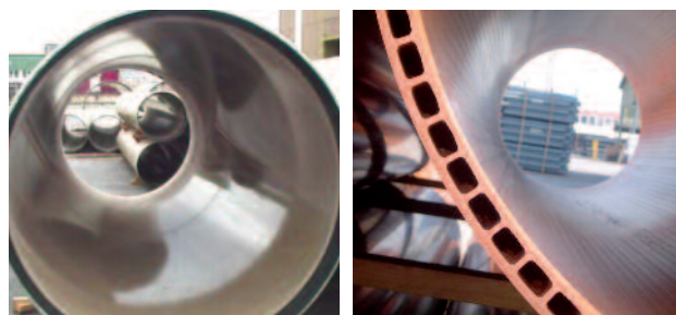
EN LAS TUBERÍAS PLÁSTICAS EL COEFICIENTE DE ROZAMIENTO INTERNO ES MÍNIMO.
