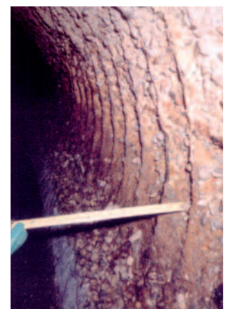
EFFECTOS DE LA CORROSIÓN EXTERIOR E INTERIOR EN TUBERÍAS.
