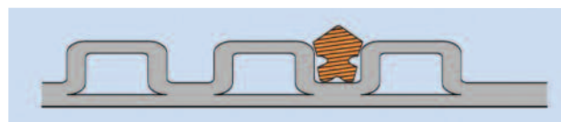
JUNTA DE SIMPLE ANCLAJE EN adecuada SANECOR® DN630-1200.
