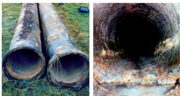
TUBERÍAS QUE HAN SUFRIDO ATAQUES POR CORROSIÓN ELECTROQUÍMICA.
