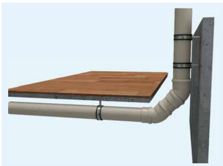
(Fig. 9). Cambio de dirección gradual.
