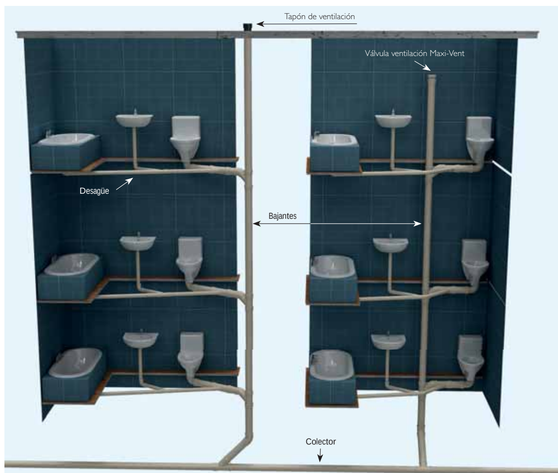
(Fig. 14). Esquema ventilación primaria
