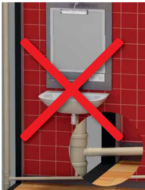
(Fig. 6). Utilización de pasamuros
