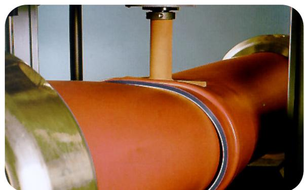
*Incluso con una deformación extrema de un 30% la copa del tubo permanece estanca*
