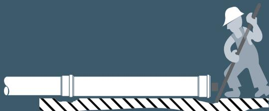
Conexión con palanca (colocar debajo madera)
